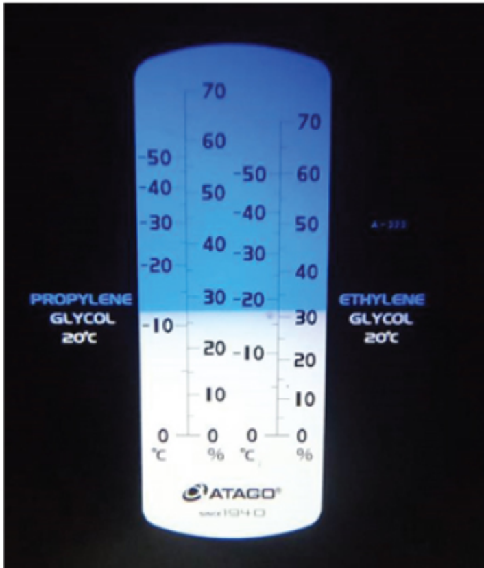
การวัดสาร Glycol ที่ได้ค่าตามที่กำหนด (ปริมาณค่าของสาร Glycol ขึ้นอยู่กับ การออกแบบของซิลเลอร์แต่ละเครื่อง)
